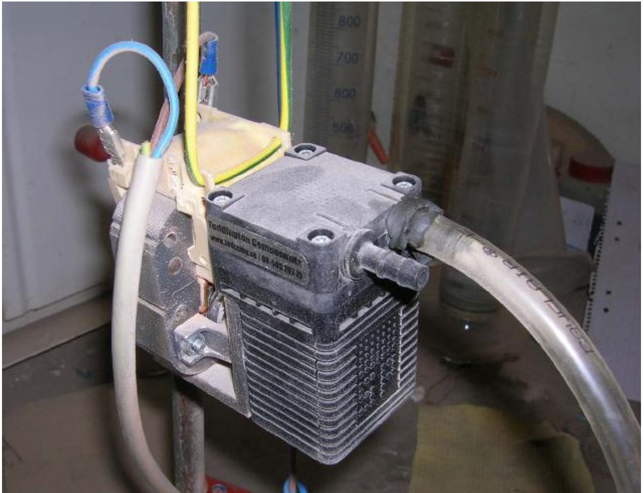
Figur 5 Luftpump (Teddington SP 720 EC) som användes i försöket. Pumpen gav en lufthastighet på 60 cm/s.
